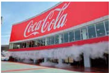
現できると言い出して、庭園に使用されることが急増。電気代は一般的なクーラーの四分の一なので、二十四時間使い続けても安心だ。また、ミストの粒子が細かく、ミストの効果はそのままなのに服も体も全く濡れないのである。マツダスタジアムでは、テレビで映るたびに「あの凄まじい霧は何だ」という問い合わせ電話が鳴り続けるそう。水の微粒子が気化するときのヒンヤリ感は、見ているだけで涼しくなる。
